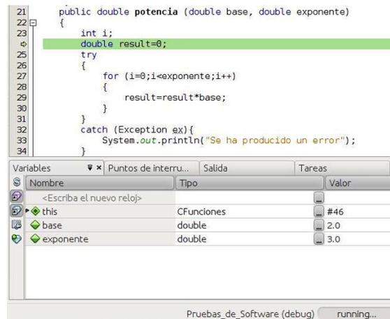
Como podemos apreciar, en una ejecución paso a paso, el programa llega a una función de nombre potencia. Esta función tiene definida tres variables. A lo largo de la ejecución del bucle, vemos como la variable **result**, van cambiando de valor. Si con valores de entrada para los que conocemos el resultado, la función no devuelve el valor esperado, "Examinando las variables" podremos encontrar la instrucción incorrecta.
